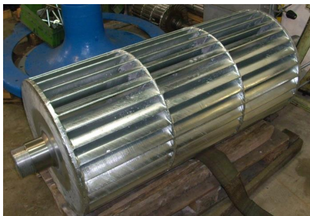
Obr. 18 Bánkiho turbína MVE Pod Zámkem 118
